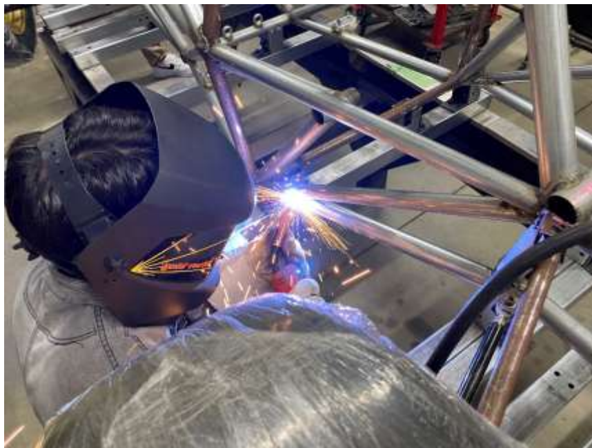
図2 車両製作の様子
